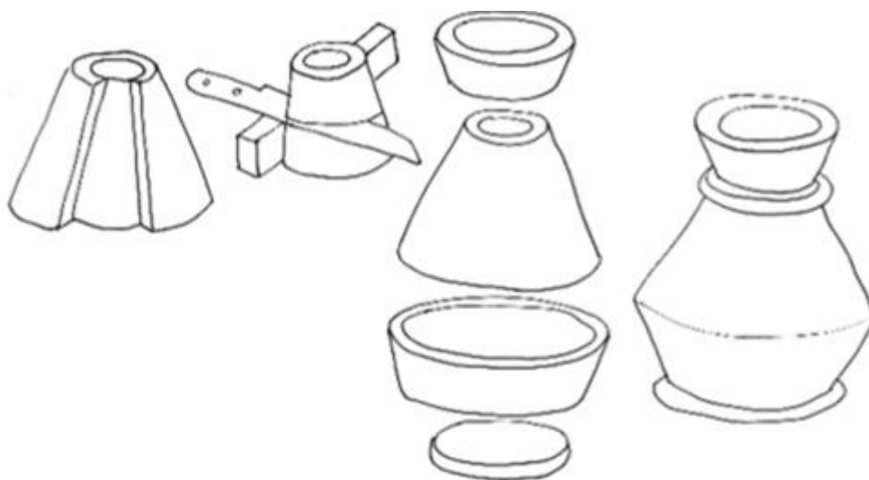
Рис. 6.4. Сборка сложной формы сосудов
