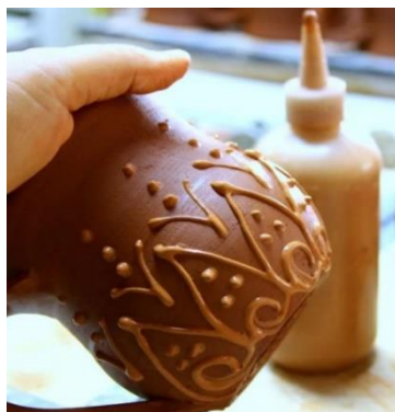
Рис. 5.18. Калячница для декорирования изделий из керамики
