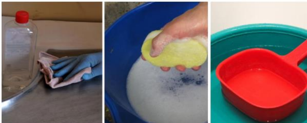
Обезжиривание происходит последовательно: 1 этап – использование специального обезжиривателя, 2 – мыльная вода, 3 – обычная вода
