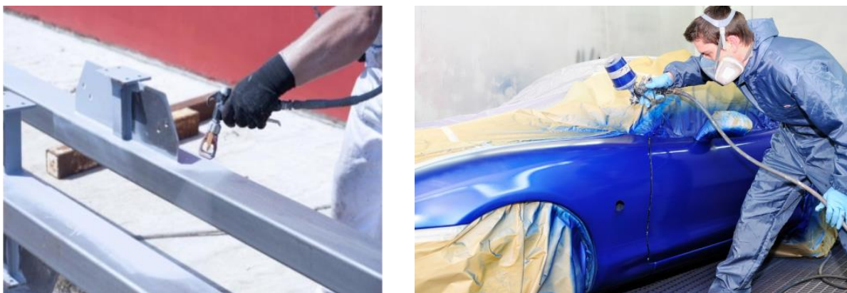
Рис. 5.4. Нанесение краски с помощью краскораспылителя
