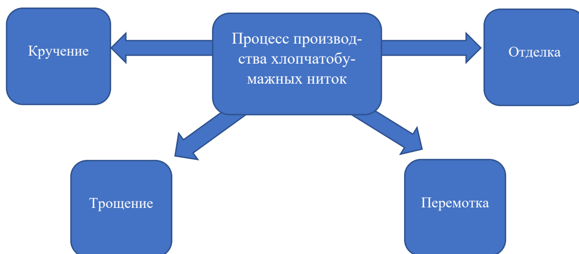
Рис. 3.1.2. Процесс производства хлопчатобумажных ниток
